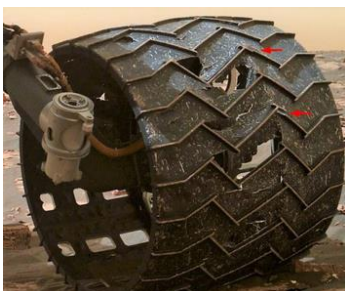
Figuur 8 - Slijtage aan de wielen van Curiosity
