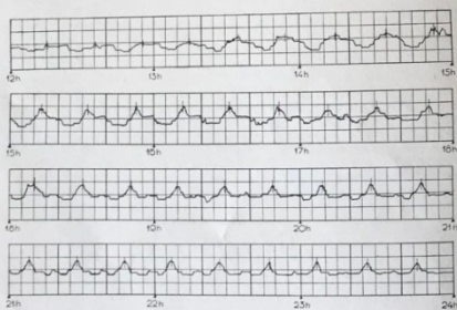
Registratie van kosmische golven. Figuur 3. De gegolfde lijn is een grafiek van de energie die een ontvanger, afgestemd op 14,6 m in de loop van 12 uren ontving. In horizontale richting zijn de tijdstippen afgezet. De maxima — door verticale streepjes aangeduid — vallen op de tijdstippen waarop de antenne — zie figuur 2 — naar een gedeelte van de melkweg was gericht. De antenne draaide elke 20 minuten een maal om zijn as. In de hierbovenstaande grafiek is telkens na een omwenteling een dikke lijn getekend. Het registragram werd op een Septemberdag vervaardigd. Tussen 12 en 13 uur maakte de melkweg een kleine hoek met de horizon; de maxima zijn dus breed en vlak. In de volgende uren richtte de melkweg zich op, de maxima zijn scherper. Tussen 21 uur en 22 uur zijn zelfs twee maxima — een hoog en een laag — te bespeuren. Het hoge maximum wordt veroorzaakt door de melkweggebieden rondom het sterrenbeeld Schutter, waar de kern van het melkwegstelsel zich bevindt. Het lage maximum wordt toegebracht door de daartegenover gelegen gebieden van de melkweg — nabij de Tweelingen.
